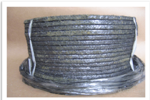
Guarnizioni contenenti amianto.
